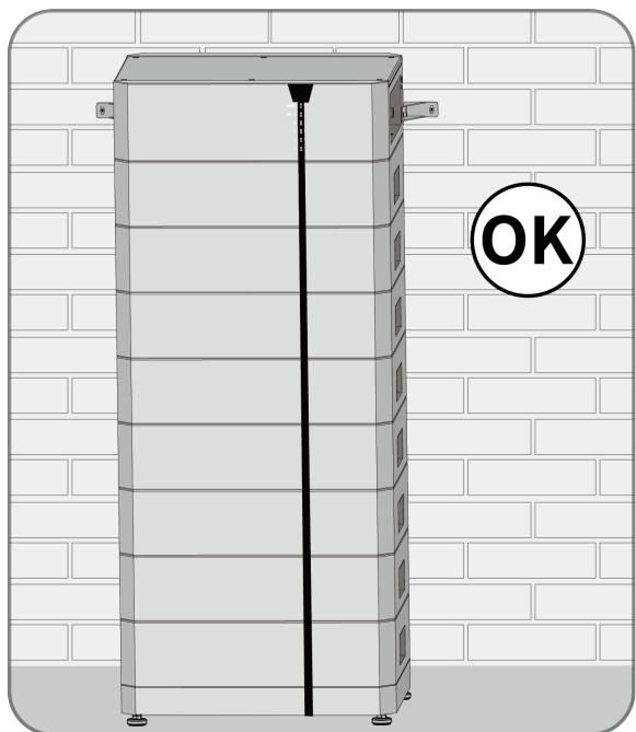
**Step 10:** Secure the hanger using screws(M8×40).
