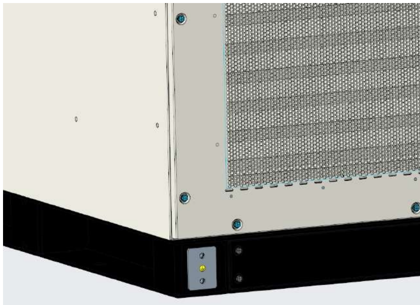
30. ábra. A földelési pont sematikus ábrája
