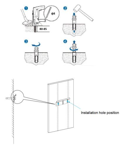
Fig. 4.2.2 Installing Backplane
