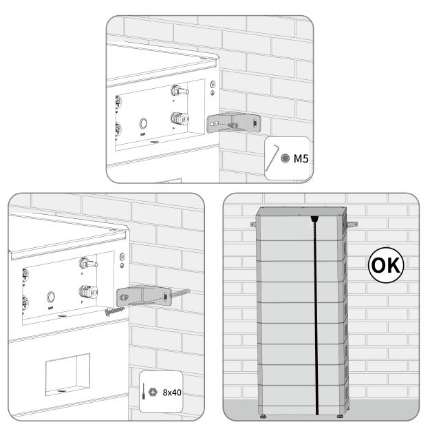
**Step 10:** Secure the hanger using screws(M8×40).
