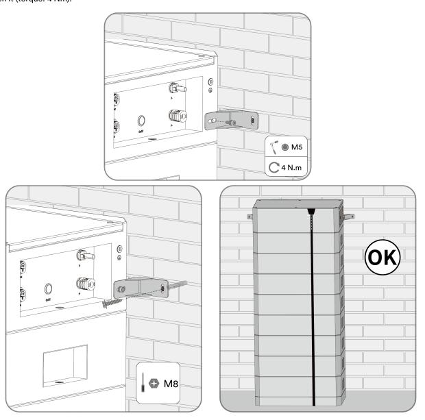
**Step 10:** Secure the hanger using screws(M8×40).
