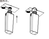
拆卸数据采集棒时,请按下图所示**逆时针旋转浮** 动螺母,数据采集棒取下后请顺时针拧紧防尘帽, 保证逆变器防护。
