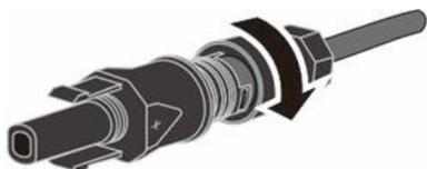
3. Para soltar el conector de CC, introduce un destornillador de punta plana (ancho de punta: 3,5 mm) en el mecanismo de retención lateral y haz palanca para abrirlo.
