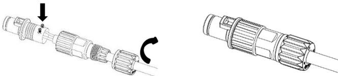
2. Rimuovere il cappuccio antipolvere dal terminale del connettore del misuratore e collegare la spina del misuratore.
